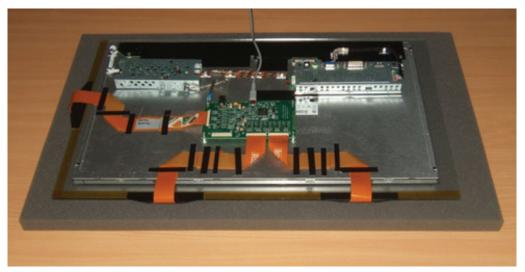
FIGURE 20 USB CABLE PLUGGED INTO CONTROLLER PCB
