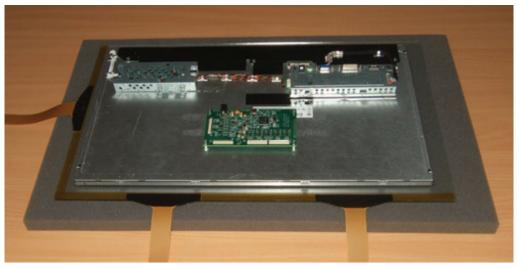
FIGURE 6 CONTROLLER POSITION ON REAR OF LCD
