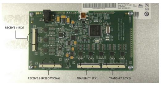
FIGURE 7 CONTROLLER PCB
