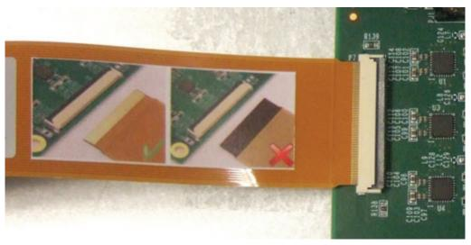
FIGURE 15 LABEL SHOWING STANDARD FLEXIBLE CABLE INSERTION ORIENTATION
