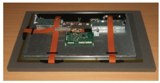
FIGURE 11 INITIAL ROUTING OF FLEXITAILS
