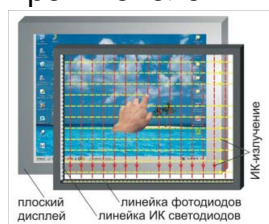
Рис. 1 - Устройство инфракрасного сенсорного экрана
